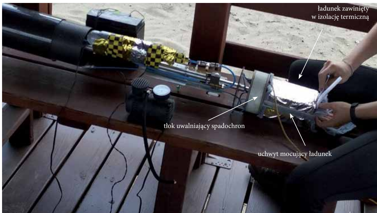
Ryc. 4. System montowania ładunku w rakiecie „Carbonara” (fot.: archiwum prywatne AGH Space Systems).
