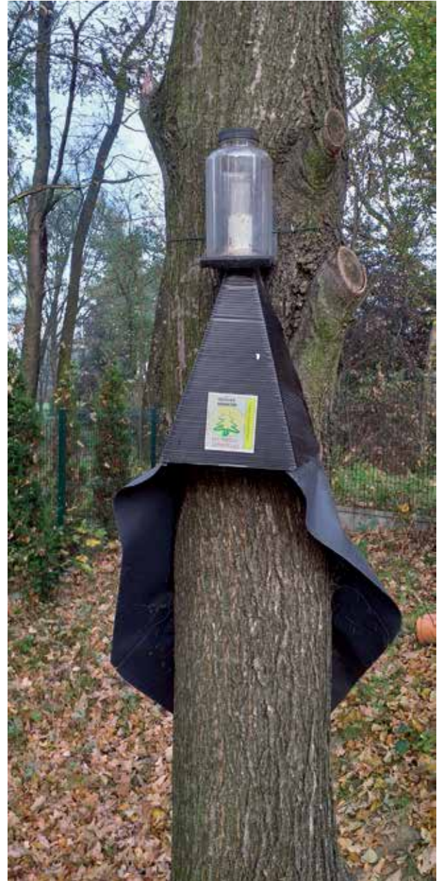
Ryc. 3b. Pułapka kołnierzowa „Geolas” jest stosowana do prognozowania wielu owadów leśnych, Fot. M. Kosibowicz.
