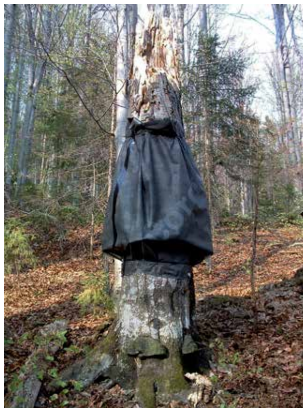
Ryc. 5. Fotoeklektor pniowy stosowany do badań faunistycznych, Fot. M. Kosibowicz.
